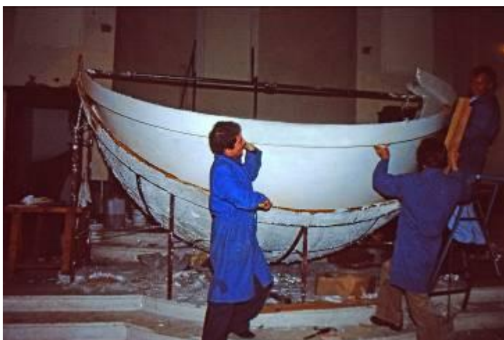
Fig. 2 - Démoulage d'un secteur en résine polyester-fibre de verre (1979).
