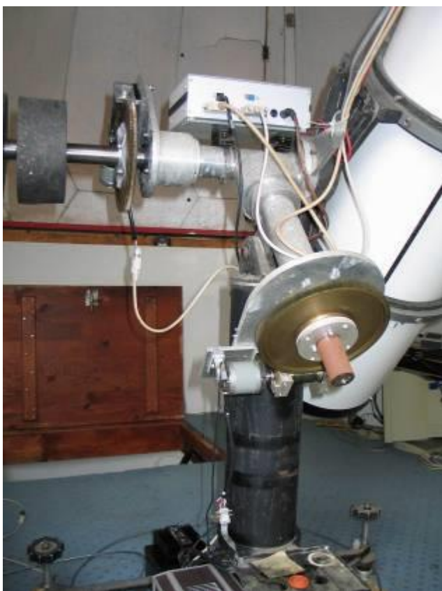
Fig. 27 - Télescope T 318 entraîné par des moteurs pas-à-pas.
